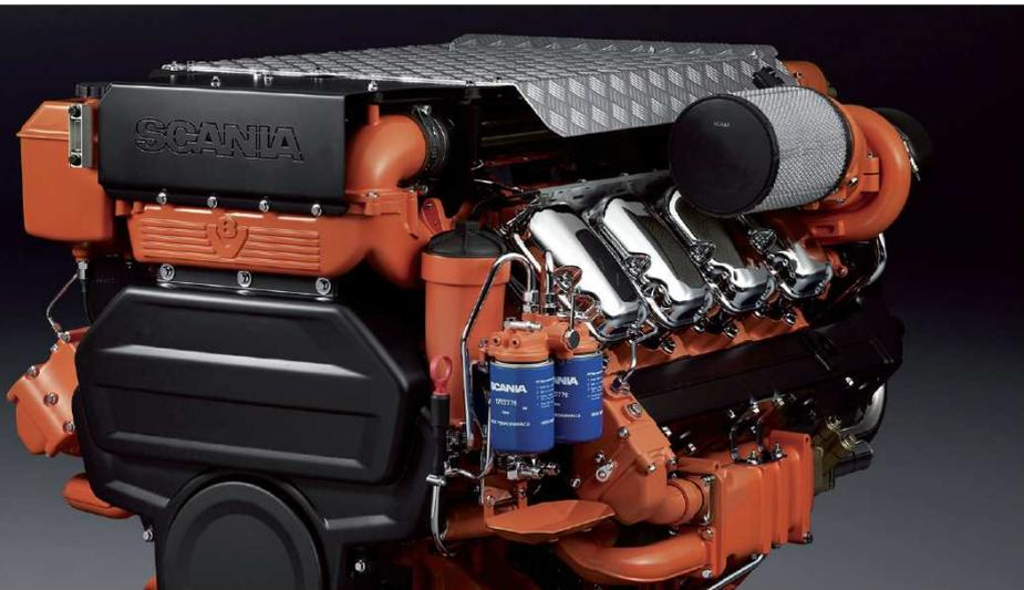
Судовые двигатели Scania имеют надежную конструкцию с усиленным блоком цилиндров, содержащим мокрые гильзы цилиндров, которые при необходимости можно легко заменить. Индивидуальные головки цилиндров с 4 клапанами на цилиндр способствуют экономии топлива и ремонтной технологичности. Двигатели имеют сертификаты о типовом одобрении от всех ведущих классификационных обществ, включая Российский морской и Российский речной регистры.
