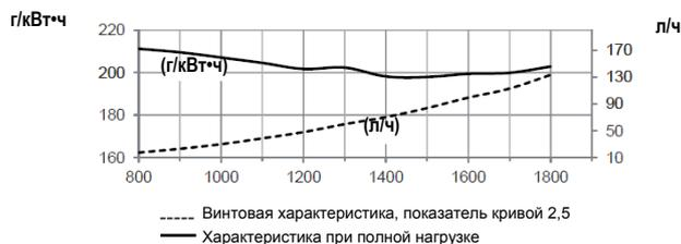
Условия испытаний Температура воздуха + 25 °С. Атмосферное давление 100 кПа (750 мм рт. ст.) Влажность 30 %. Дизельное топливо согласно ECE R 24, приложение 6. Плотность топлива 0,840 кг/дм<sup>3</sup>. Вязкость топлива 3,0 мм<sup>2</sup>/с при 40 °С. Теплота сгорания 42 700 кДж/кг.
